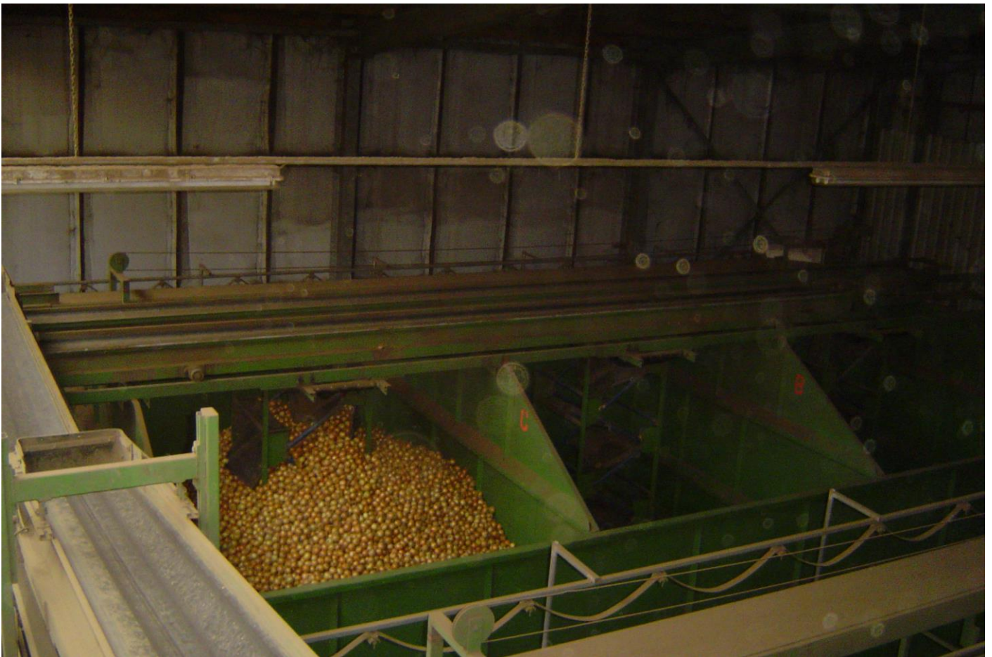
Het hele proces gebeurt met valbrekertjes zodat geen enkele ui een beschadiging kan oplopen.
