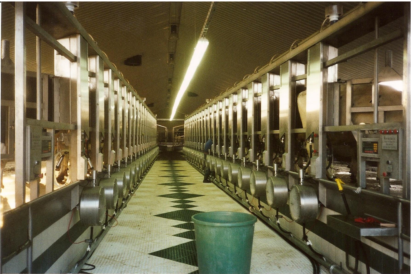
Germania melkstallen zogenaamde 2 keer 20, twee rijen van 20 koeien tegelijk met een capaciteit van 140 koeien in een uur melken welke door één persoon kan worden bediend.
