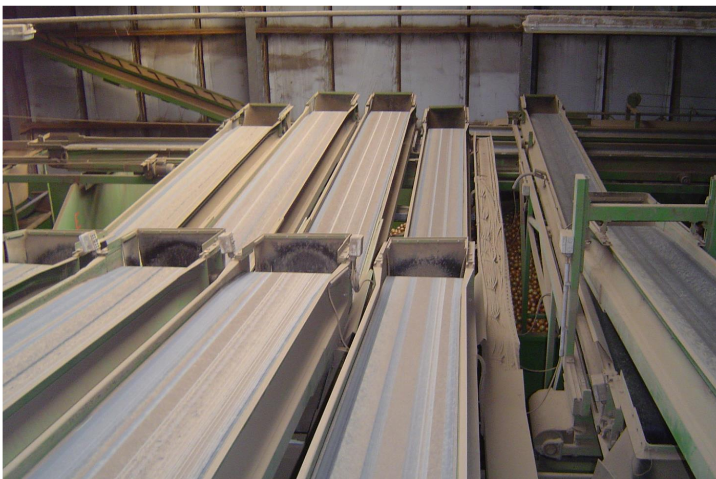
De uien lopen over rijen transportbanden naar de voorraadbunkers.
