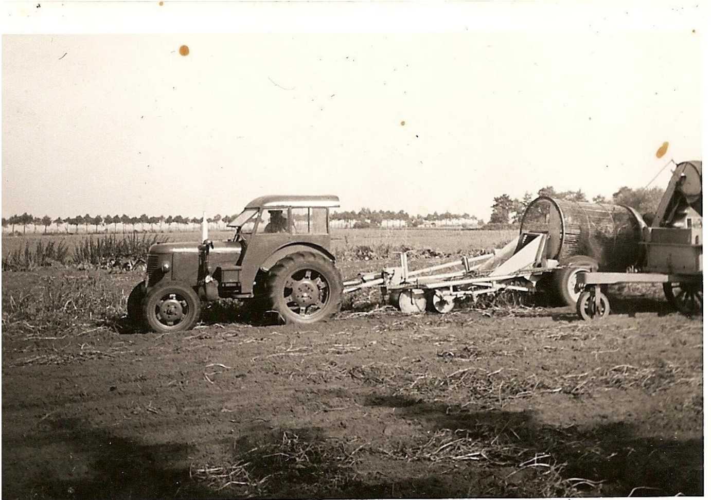
1955; De eerste aardappelrooimachine. Merk Sterbo kostte toen achttijfhonderd gulden. Ernaast loopt een Wipkar om de aardappelen op te vangen.
