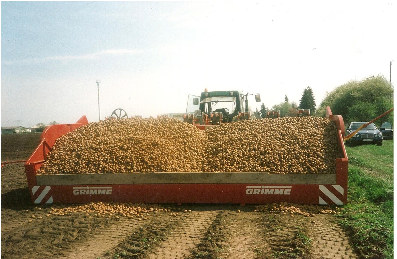
Acht rijen aardappelpootmachine met acht ton poters in de bak.
