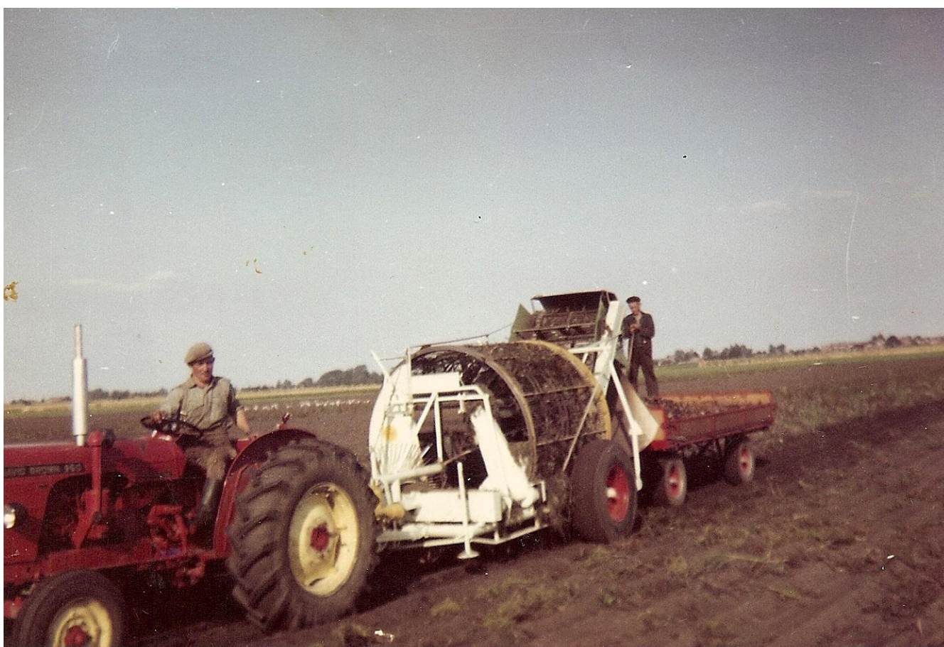
Climax aardappelrooimachine. Schelto zijn tweede rooimachine. De aardappelen werden in een mand opgevangen en van uit de mand achter op de wagen gegooid. Het boerenbedrijf werd in hoog tempo gemechaniseerd: maaidorsers, bietenrooiers, aardappelrooimachines en kiepwagens werden in hoog tempo door boeren aangeschaft.
