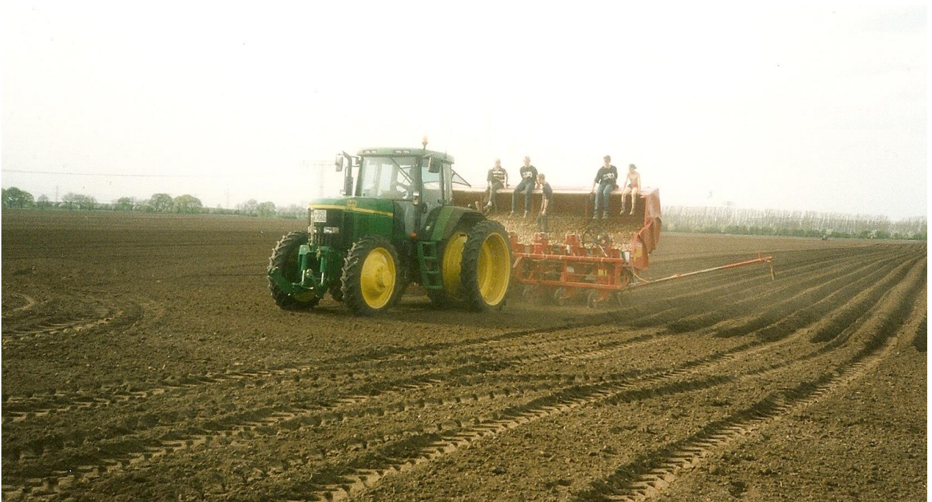
John Deere tractor met een 8 rijen aardappelpootmachine. Neemt 8 ton poters mee in de bak.
